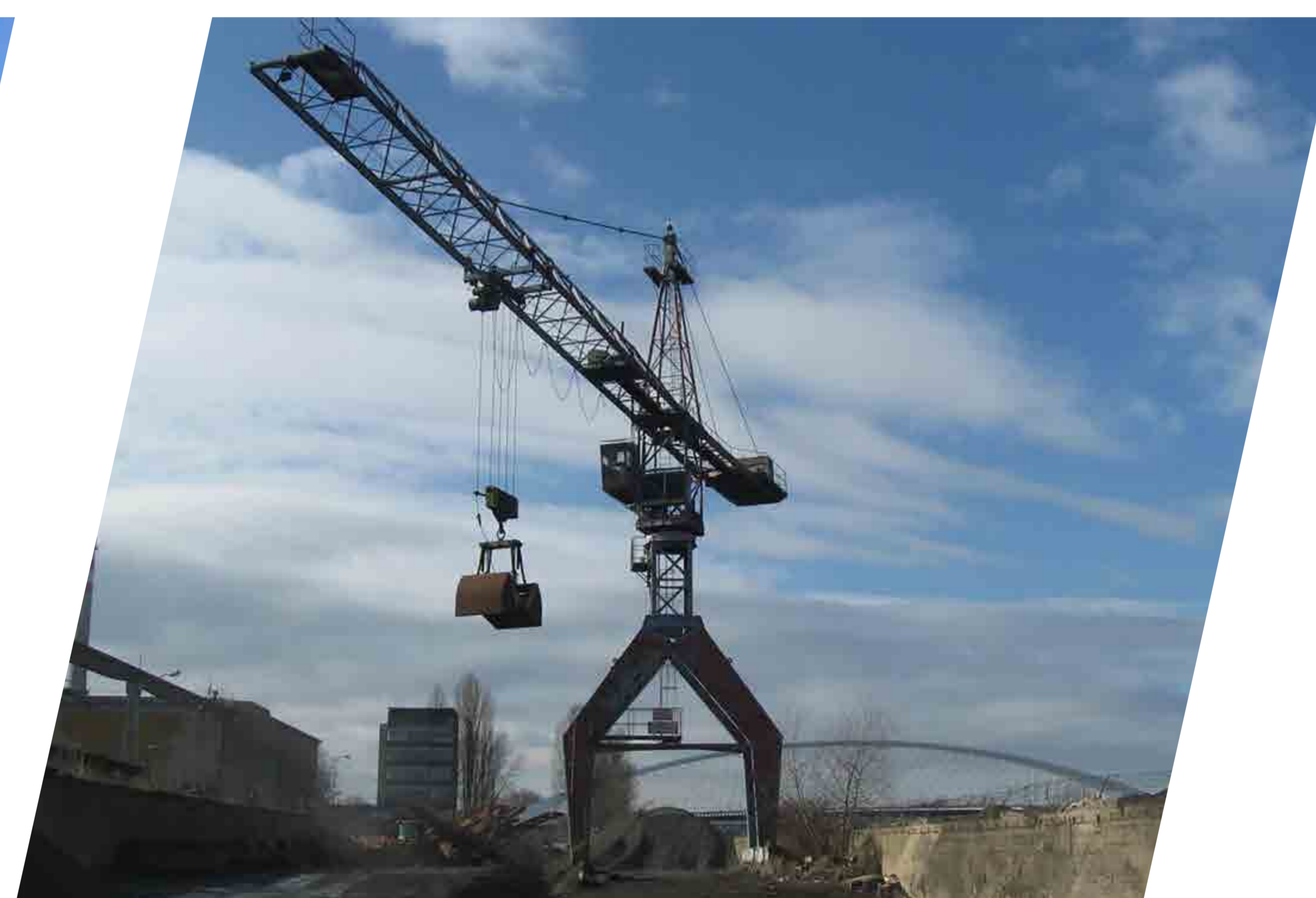
Věžový jeřáb typ MB 1645 o nosnosti 6 tun, odstraněn 2014.
